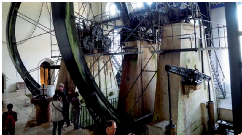
Rechts unterhalb des Wasserrades sind die Pleuelstangen zu erkennen.
