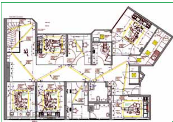
Lichtkonzept für eine Zahnarztpraxis von Fatih Yetgin. Jedes Lichtkonzept erfordert Planung und gestalterische Vorstellungskraft, sonst ist Licht zu hell, zu dunkel oder einfach unangenehm.
