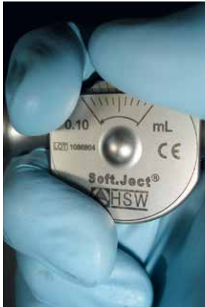
Abb. 3: Mittels des Dosierrads kann Druck auf- und abgebaut werden.
