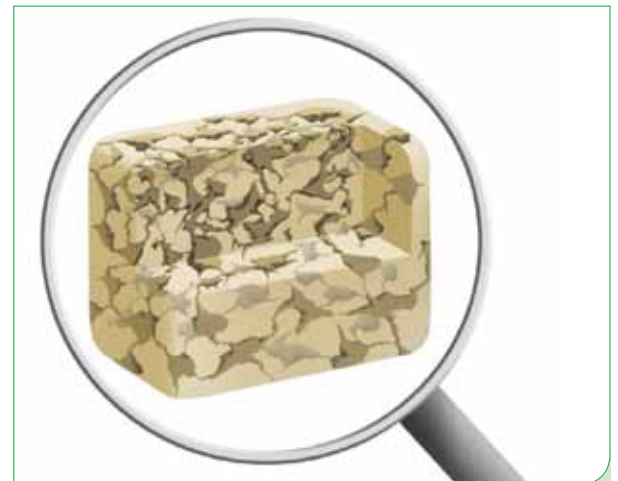
Abb. 7: Schematische Darstellung des Gefüges von VITA Enamic mit den zwei sich durchdringenden Netzwerken aus Kunststoff und Keramik.
