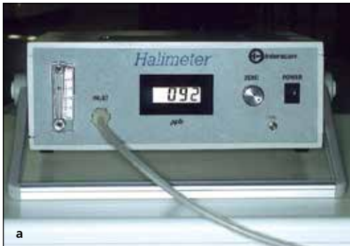
Abb. 6a u. b: Geräte zur Testung von Halitosis: Halimeter™ und OralChroma™.
