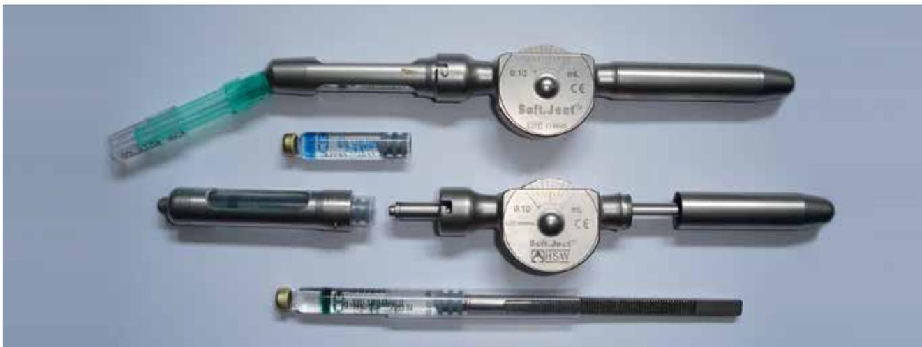
Abb. 2: DIN-genormte Dosierrad-Spritze (DIN 12989:2013-10).
