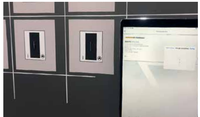
Abb. 2: Auf schwarzer Schablone erkennt Checkomet das Instrument. Wahlweise kann auch direkt ein Bestellvorgang ausgelöst werden.
