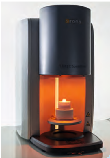
Der neue Sinterofen CEREC SpeedFire benötigt für Kronen nicht einmal eine Viertelstunde.
