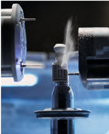
CEREC Zirconia kann mit der CEREC Schleif- und Fräseinheit trocken gefräst werden.
