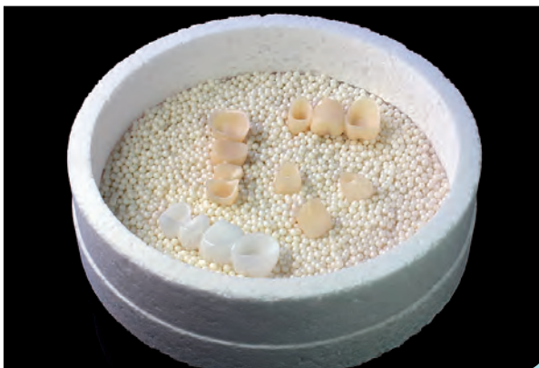
Abb. 1: Optimale Auslastung des Brennprozesses durch gleichzeitiges Sintern der verschiedenen Transluzenzgrade.
