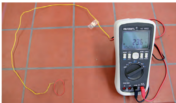
Abb. 2: Die entweichende Energie nach dem Dehnungsprozess ist physikalisch in Form einer erhöhten Temperatur am Werkstoff messbar.
