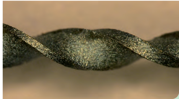
Abb. 6: Die mittels Funkenschlag gehärtete Oberfläche der HyFlex EDM unter dem Mikroskop.
