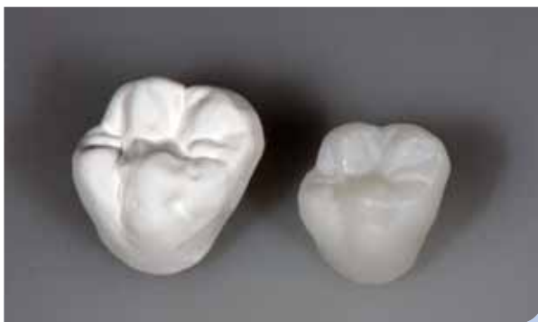
Abb. 2: Visualisierung des Sinterschrumpfs: Ge-fräste Krone aus vor-gesintertem Zirkonoxidrohling (links) und durchgesinterte Krone (rechts).
