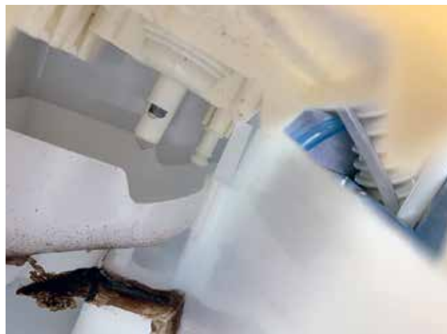
Bilder einer Dentaleinheit: von hygienischem Design keine Spur – stattdessen Befall mit schwarzem Hefepilz Exophiala spec.
