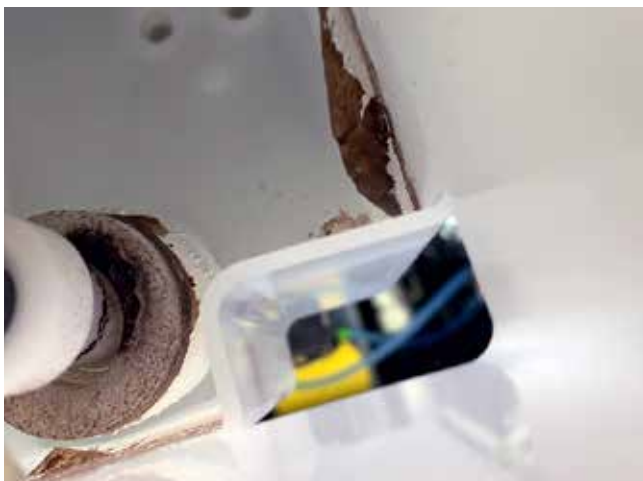
Bilder einer Dentaleinheit: von hygienischem Design keine Spur – stattdessen Befall mit schwarzem Hefepilz Exophiala spec.
