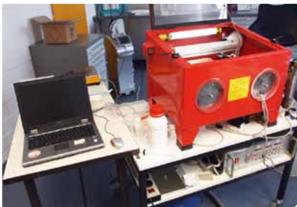
Abb. 1: Ein eigens entwickeltes Air-Box-Test-Gerät zur Durchführung der Studien.
