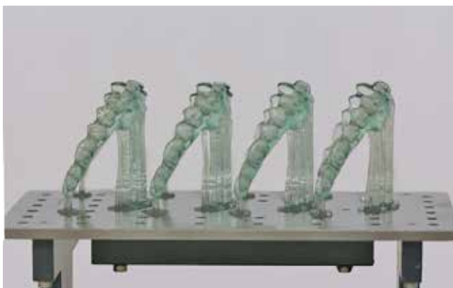
Abb. 4: Vertikal gedruckte Aufbisschienen mit Stützstrukturen auf der Bauplatte.
