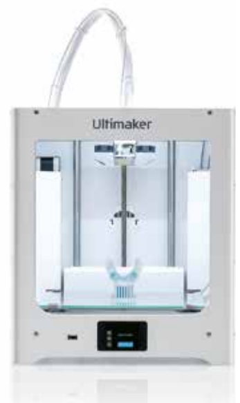
Abb. 1: Mit TrayFill gedruckter Funktionslöffel auf dem Ultimaker 2+ connect.
