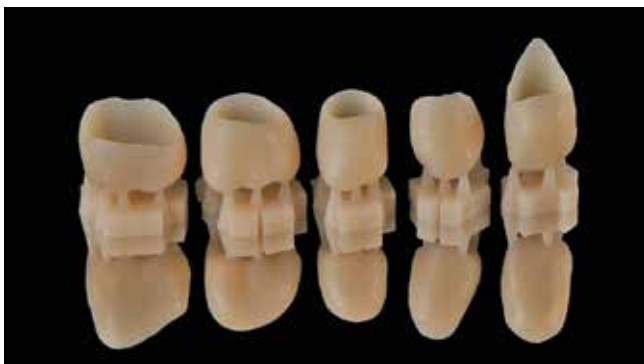
Abb. 4: Additiv gefertigte Seitenzahnkronen aus BEGO VarseoSmile Crown plus mit Stützstrukturen.
