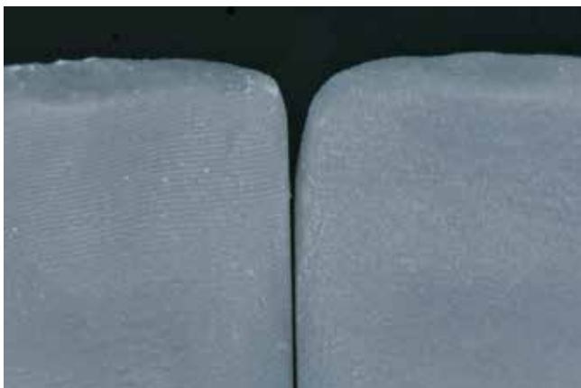
Abb. 2: Inzisalkanten eines DLP-gedruckten Modells in einer Schichtdicke von 100 µm und 25 µm.
